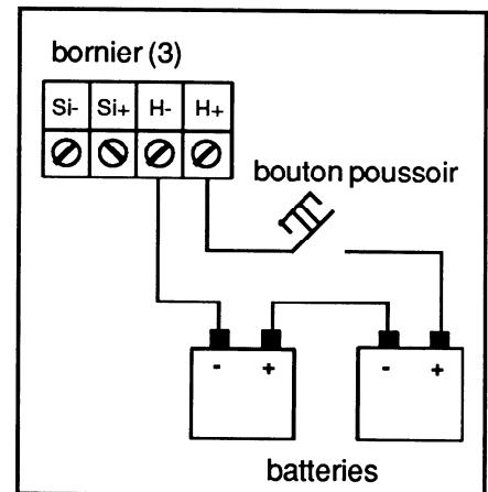
l'énergie nécessaire au fonctionnement des sirènes sera fournie par les batteries au moyen d'un bouton-poussoir à fermeture. Respecter impérativement la polarité du branchement.
